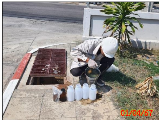
บ่อพักน้ำทิ้งบริเวณก่อนระบายออกจากพื้นที่โครงการ
